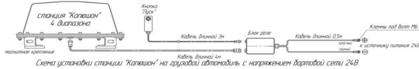
Схема установки станции "Копюшон" на грузовой автомобиль с напряжением бортовой сети 24В
