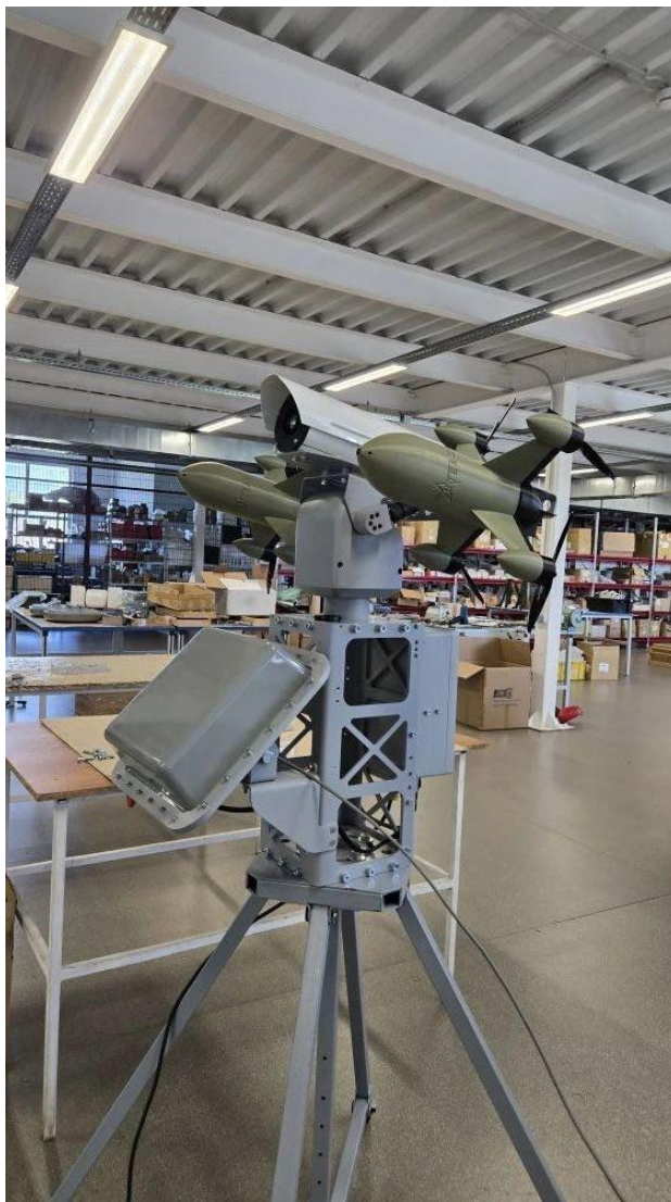
Пример конструктивной интеграции комплекса с БПЛА-перехватчиками.
