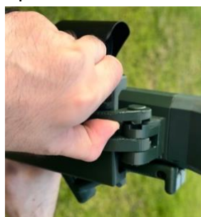
Крепление монитора поднимаем вверх, после чего поворачиваем механизм для открытия
