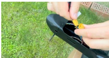
Подсоединяем разъем аккумулятора к дрону Стриж, закладываем аккумулятор в отсек, закрываем крышку дрона перехватчика Стриж, дрон перехватчик Стриж готов к работе.
