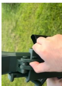
Крепление монитора поднимаем вверх, после чего поворачиваем механизм для открытия
