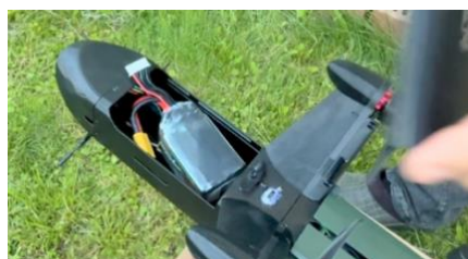
Подсоединяем разъем аккумулятора к дрону Стриж, закладываем аккумулятор в отсек, закрываем крышку дрона перехватчика Стриж, дрон перехватчик Стриж готов к работе.
