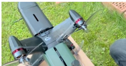
Устанавливаем лопасти на дрон Стриж, открываем крышку дрона перехватчика Стриж
