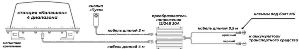
Схема установки станции Капюшон на грузовой автомобиль с напряжением бортовой сети 24В
